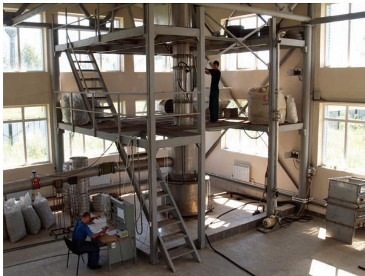
**Стенд для гидродинамических испытаний
