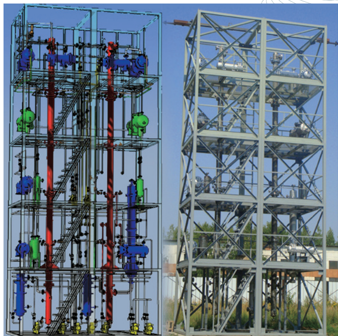
Технологический модуль колон ректификации (слева — модель, справа — ее реализация), входящий в состав экспериментальной установки научно-технологического центра ОАО «Нижнекамнефтехим»
