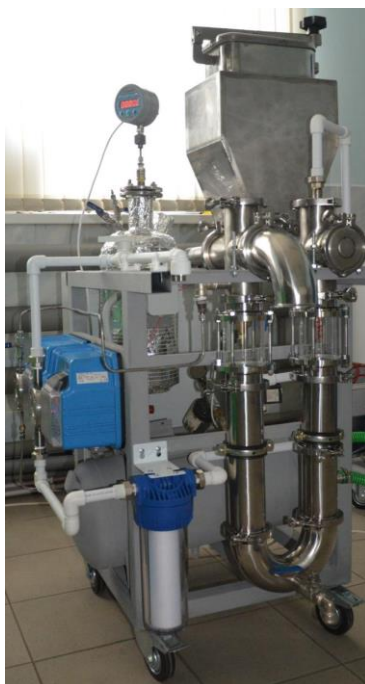
Рис. 3. Пилотная пульсационная установка (ППУ) для экстрагирования
