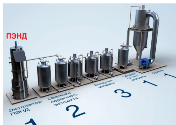
Рис. 6. Линия получения растворимого порошка цикория после модернизации с применением ПЭНД производительностью 400 кг/ч по исходному обжаренному цикорию
