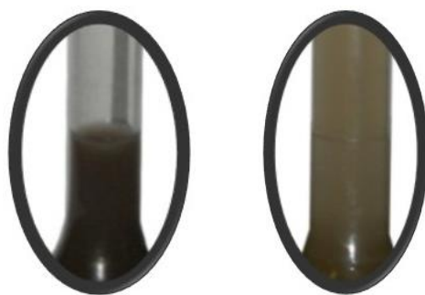
Рис. 4. Сопоставление светлости диффузионного сока. Слева: диффузионный сок, полученный в традиционном диффузионном аппарате (РДА на ООО «Буинский сахар»). Справа: диффузионный сок, полученный в ДПА
